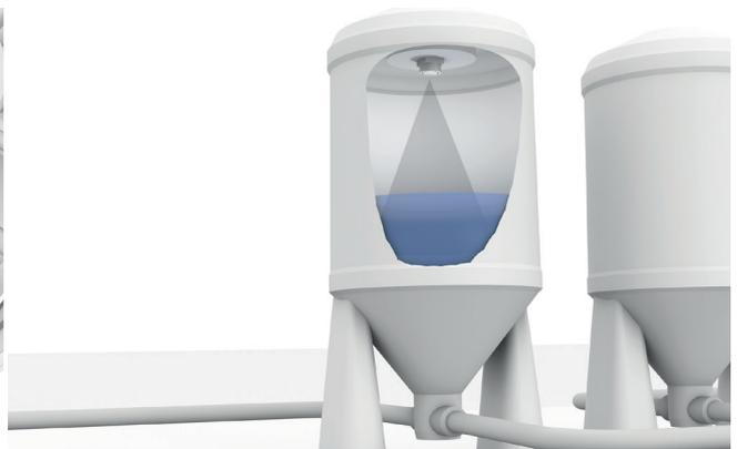
Sensores de ultrassom verificam a altura de abastecimento de tanques.
