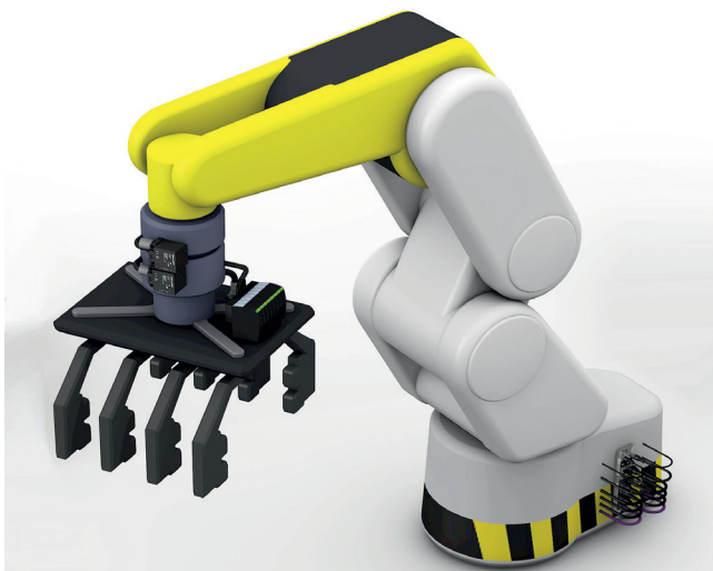
Bezdotykowa transmisja sygnałów pomiędzy chwytakiem a ramieniem robota
