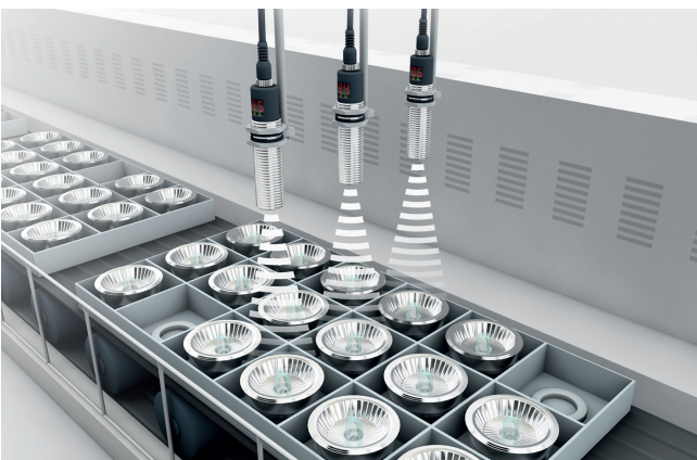
Elementy kontrolowane są podczas transportu pod względem obecności, położenia i kompletności.
