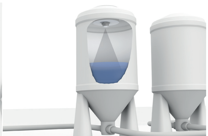
Misurazione del livello di riempimento di liquidi in un serbatoio con sensori a ultrasuoni
