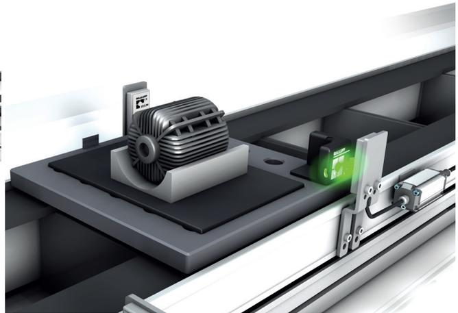
Letture del supporto dati tramite testina di scrittura/lettura RFID con unità controller dedicata, concepita per spazi ridotti
