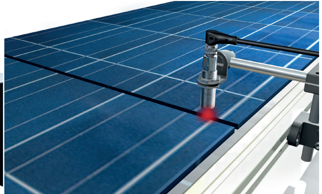
I sensori optoelettronici rilevano senza contatto le celle fotovoltaiche nel processo produttivo.
