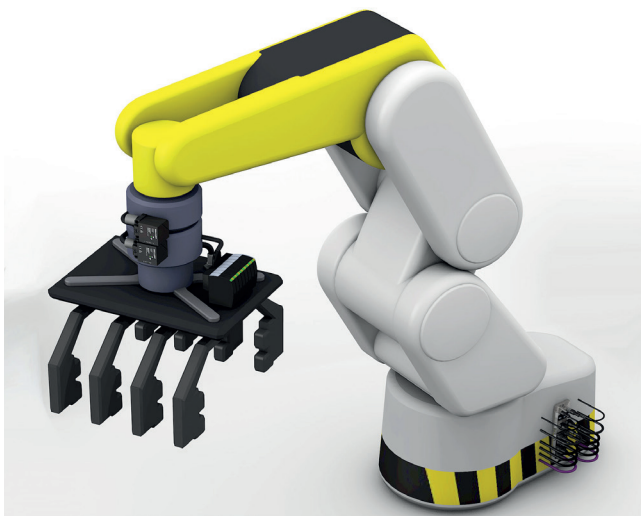
Transmission sans contact des signaux entre la pince et le bras de robot
