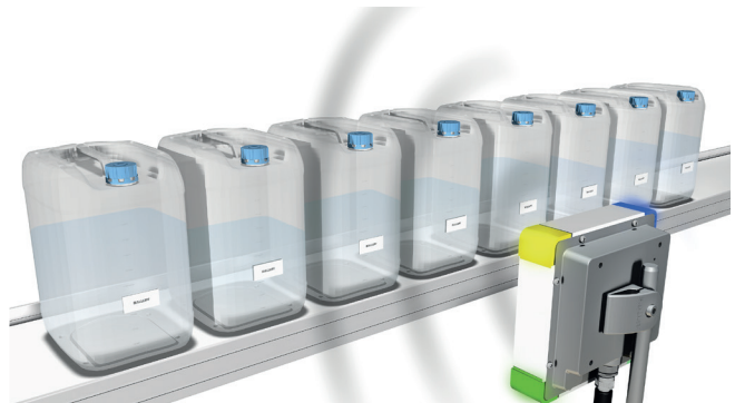
Marquage personnalisé du produit individuel et saisie simultanée de plusieurs supports de données avec RFID UHF
