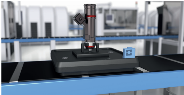
Tag RFID fixé sur un porte-pièces, qui contient les données relatives à la procédure de montage pour la pièce
