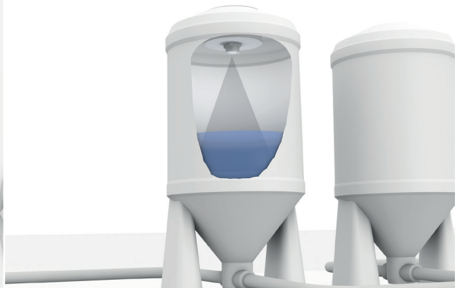
Medición de nivel de llenado de líquidos en un depósito con sensores ultrasónicos
