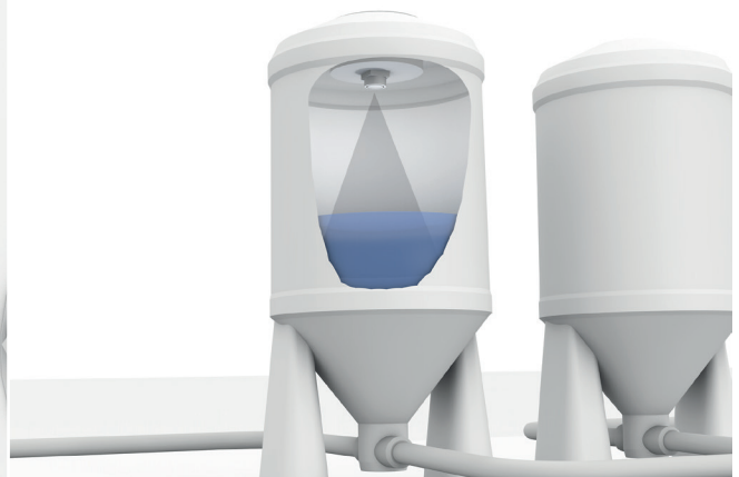
用超声波传感器测量液体在储罐中的液位
