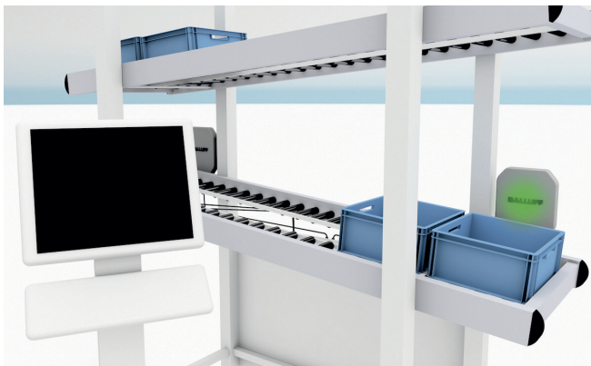
HF或UHF读头通过看板货架中装备有数据载体的容器采集数据
