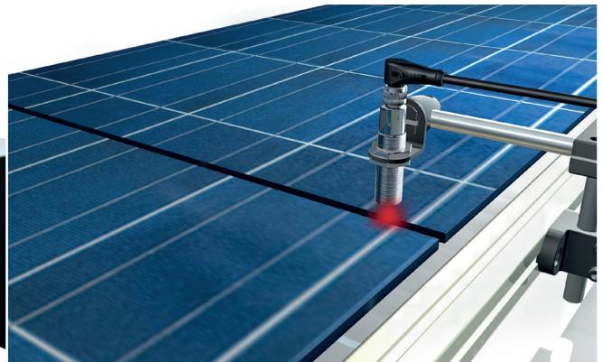
光电传感器在生产过程中非接触式探测光伏电池。
