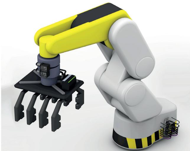
Transmissão sem contato dos sinais entre o braço das garras e o braço do robô
